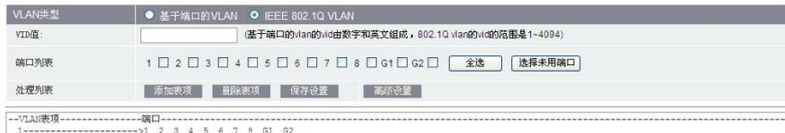
图 4-24 IEEE 802.1Q VLAN 配置界面图
